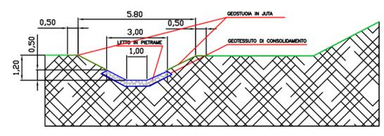
PARTICOLARE B – SEZIONE LONGITUDINALE CANALE
